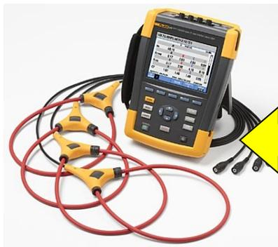
Analyse des réseaux et équipements électriques
